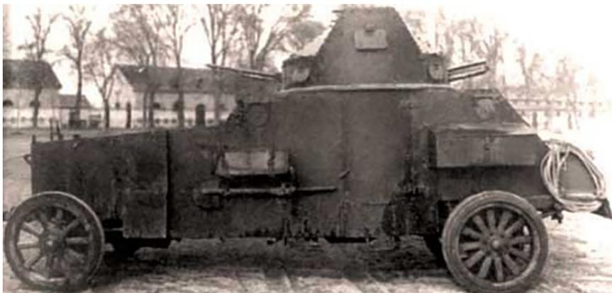
Рис. 4. Пушечно-пулеметный броневладелец «Уайт АМД»
