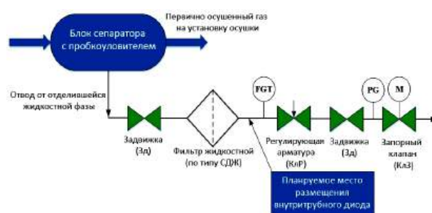
Рис. 3. Схема размещения исследуемого внутритрубного диода Fig. 3. Scheme of the in-pipe diode location
