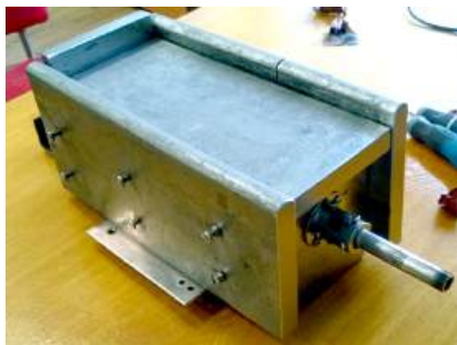
Рис. 3. Зонд для измерения зарядового состава струи ионных двигателей Fig. 3. Wien filter of the electric propulsion diagnosis
