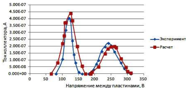
Рис. 5. Экспериментальная и рассчитанная ВАХ в струе ионного двигателя Fig. 5. Experimental and calculated Wien filter signal in the ion engine
