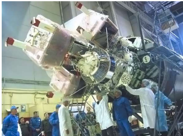
Рис. 2. Адаптер для группового запуска КА на РН «Космос-3М»
