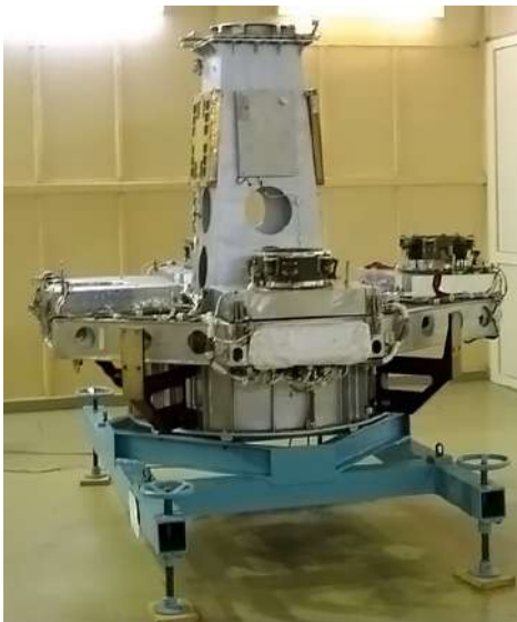
Рис. 2. Адаптер для группового запуска КА на РН «Космос-3М»
