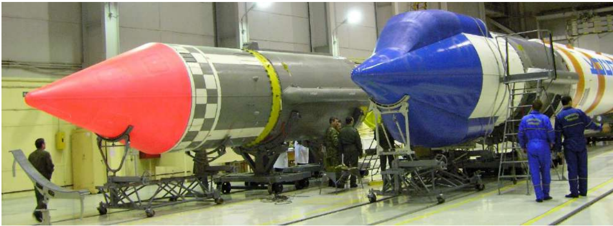
Рис. 1. РН «Космос-3М» со штатным и увеличенным головным обтекателем
