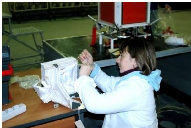
Рис. 7. Швейное изделие ракетно-космической техники — теплоизоляция спутника
