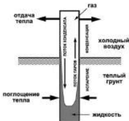
Рис. 1. Схема работы термостабилизатора
