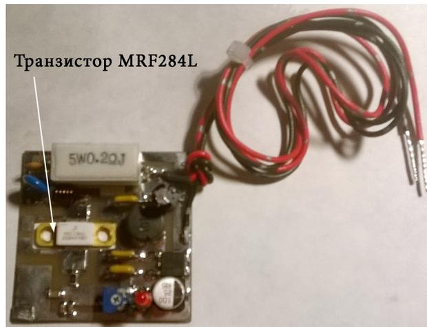
Рис. 2. СВЧ-генератор на транзисторе MRF284L
