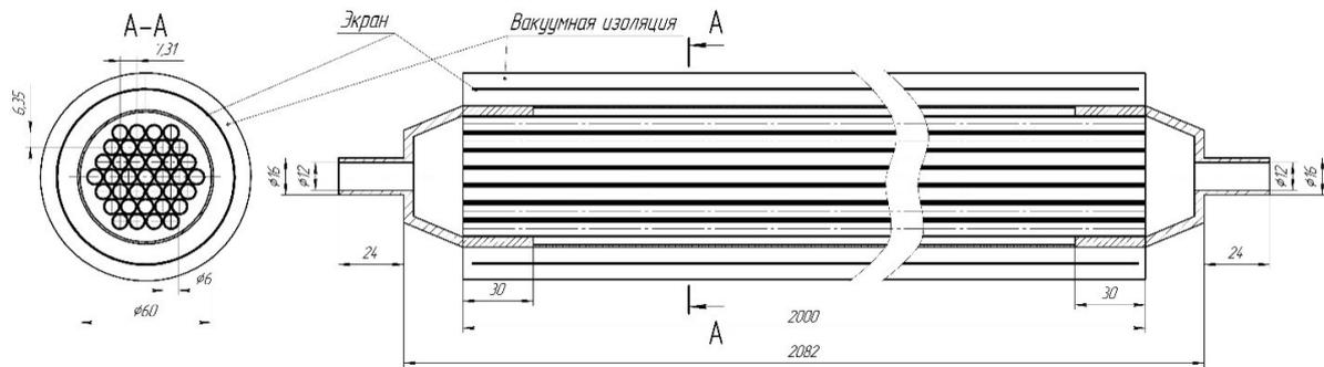
Рис. 3. Схема теплообменного аппарата с экранно-вакуумной изоляцией (1 экран)
