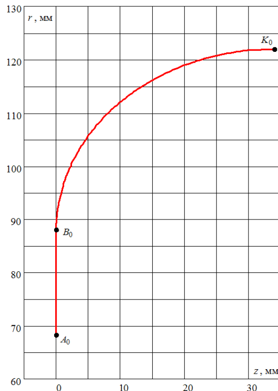
Рис. 2. Меридиан срединной поверхности резинокордной оболочки баллонного типа модели Н-50 в ненагруженном состоянии: A_0 — точка крепления оболочки к металлической арматуре; B_0 — точка перехода от прямой линии к окружности; K_0 — точка экватора Fig. 2. Meridian of the middle surface of the rubber-cord shell balloon type model H-50 in the unloaded condition: A_0 — point of attachment of the casing to metal fittings; B_0 — point of transition from a straight line to a circle; K_0 — equator point
