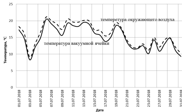
Рис. 5. Среднесуточные за темное время в июле 2018 года температуры вакуумной ячейки радиационного охладителя и окружающего воздуха Fig. 5. The average daily temperatures of a vacuum cell of radiation cooler and ambient air for a dark time in July 2018
