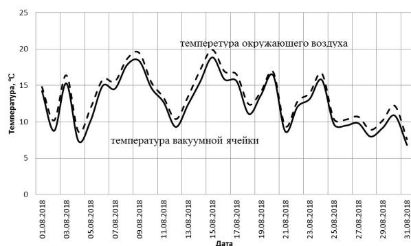
Рис. 6. Среднесуточные за темное время в августе 2018 года температуры вакуумной ячейки радиационного охладителя и окружающего воздуха Fig. 6. The average daily temperatures of a vacuum cell of radiation cooler and ambient air for a dark time in August 2018
