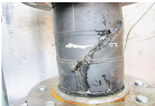
Рис. 9. Характер разрушения резинокордного патрубка типоразмера РКП-80 ( S=0 )
