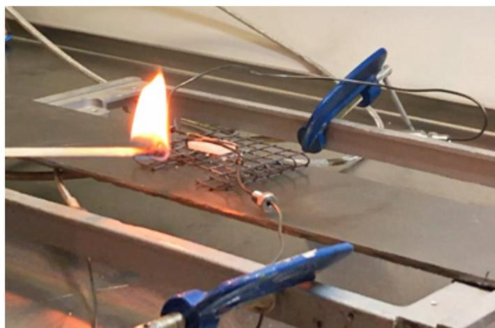
**Рис. 6. Иницирование горения с помощью открытого пламени**
