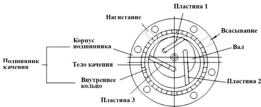
Рис. 2. Принципиальная схема компрессора
