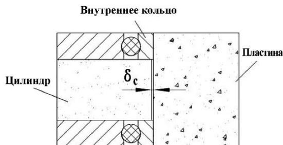
Рис. 3. Схема сопряжения кромки пластины с цилиндром и подшипником качения
