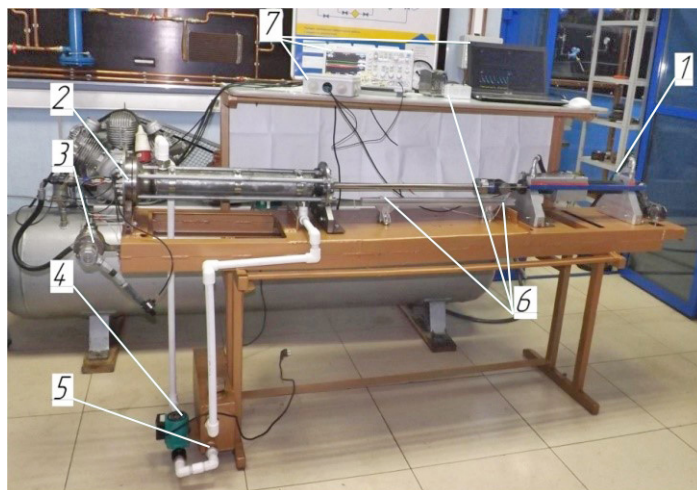
Рис. 2. Фотография второго модуля гидроцилиндр-компрессорного узла с установленной измерительной системой:
