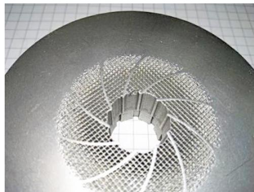
**Рис. 11. Разрез рабочее колесо турбокомпрессора с внутренними ребрами**
