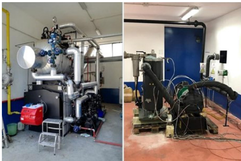
Рис. 1. Зона парогенератора (слева) и зона расширителя (справа) испытательного стенда, используемого в этой работе Fig. 1. Steam generator area (left) and expander area (right) of the test rig employed in this work
