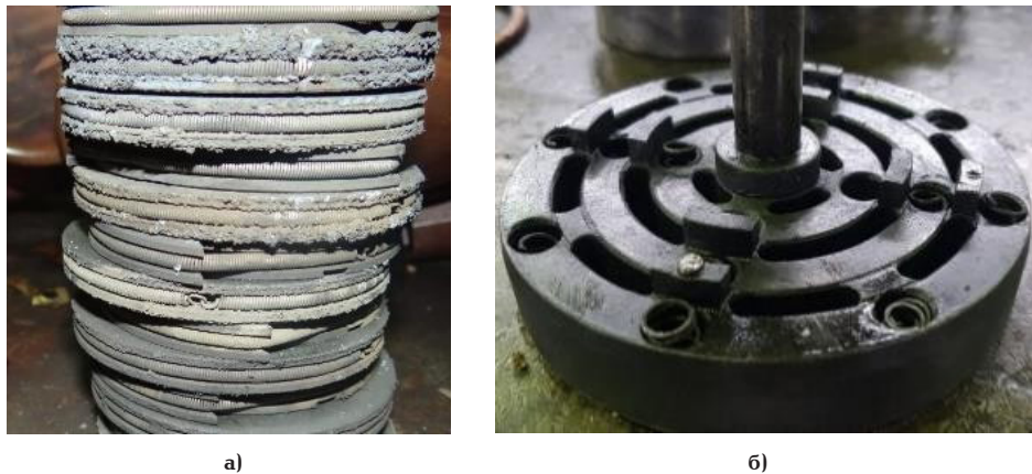
Рис. 5. а) Загрязнение газовых уплотнительных колец; б) неисправный клапан Fig. 5. a) Fouling on the gas packing rings; b) defected valve
