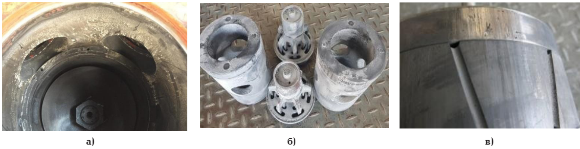
Рис. 3. Образование загрязнений в первой ступени подпиточного компрессора: а) цилиндр, б) клапаны, в) поршень коснулся гильзы цилиндра Fig. 3. Fouling formation in make-up compressor section first stage: a) cylinder, b) valves, c) piston touched the cylinder liner
