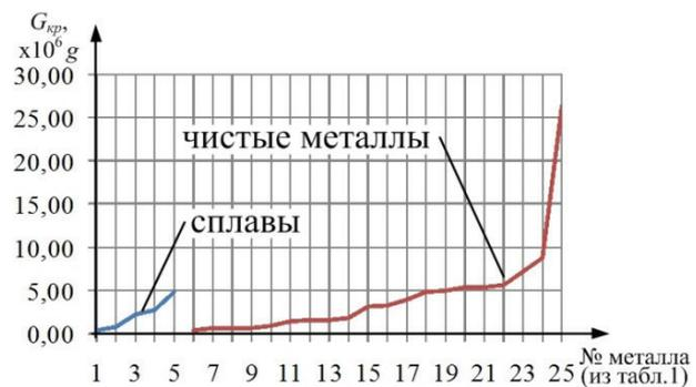
Рис. 1. Графики перегрузки металлов G<sub>кр'</sub>, приводящей к инерциальному взрыву для земных условий: для сплавов и чистых металлов
