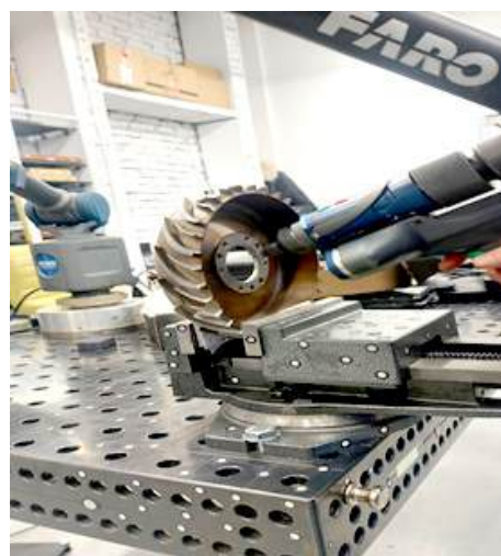
Рис. 3. Этап сканирования лопаточного диффузора Fig. 3. Scanning stage of the blade diffuser
