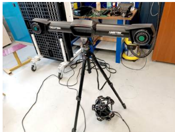
Рис. 2. 3D-сканер марки CREAFORM Fig. 2. CREAFORM 3D-scanner
