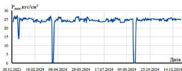
Рис. 7. График изменения давления на выходе из конденсатопровода
