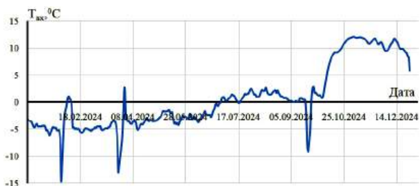
Рис. 6. График изменения температуры на входе в конденсатопровод
