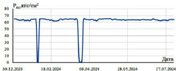
Рис. 5. График изменения давления на входе в конденсатопровод
