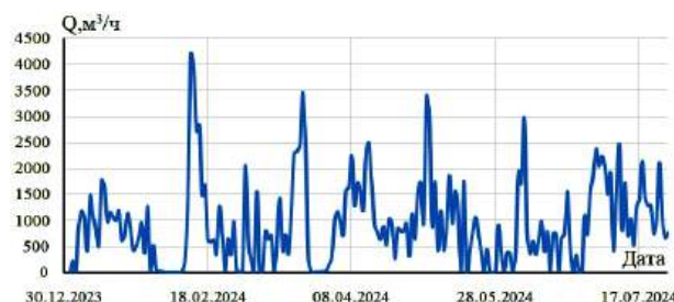
Рис. 4. График изменения расхода жидкости в технологической линии Fig. 4. Graph of liquid flow rate changes in a process line
