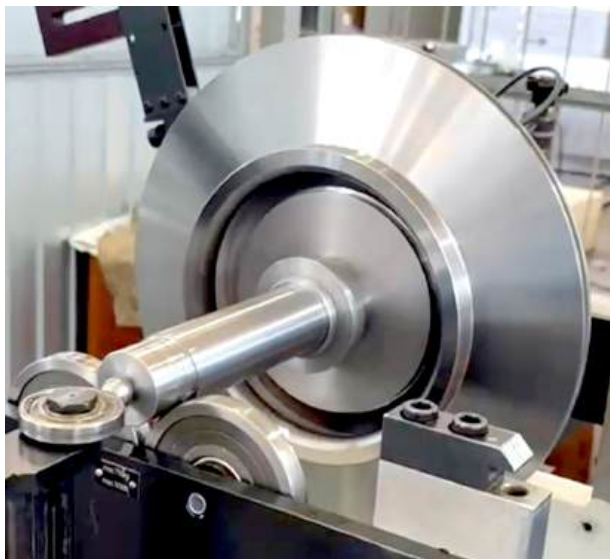
Рис. 8. Рабочее колесо на стенде Fig. 8. Impeller on the stand
