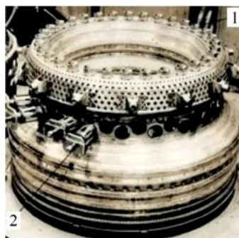
Рис. 2 Двухзонная камера сгорания: а — фото жаровой трубы; б — общий вид двухзонной камеры сгорания Fig. 2. Two-zone combustion chamber: а — photo of the flame tube; б — general view of the two-zone combustion chamber
