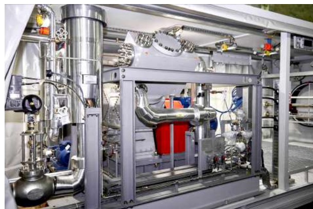
Рис. 2. Компрессорная установка МКБ (вид со стороны компрессора) Fig. 2. Mobile compressor unit (view from the compressor side)
