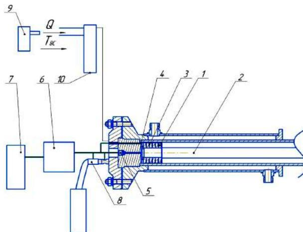
Рис. 2. Схема стенда испытаний с повышенной температурой на всасывании
