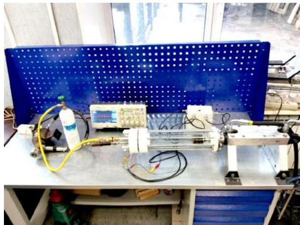
Рис. 6. Общий вид стенда испытаний тихоходного компрессора с двухфазным рабочим телом
