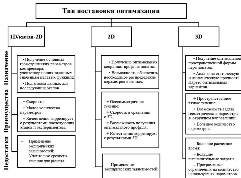
Рис. 5. Результирующая схема к подходам по оптимизации осевых компрессоров
