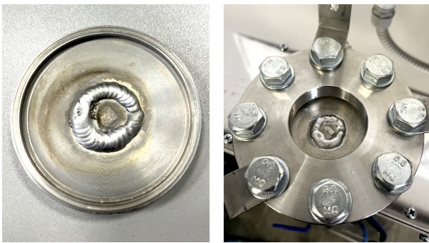
а) б) Рис. 3. ЭО со сварным швом с ГТ Fig. 3. ES with welded seam with HL
