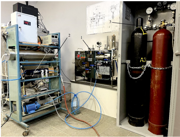
Рис. 2. Экспериментальный исследовательский стенд: 1 — стойка с ЭЭ, акустическими излучателями и метрологическим оборудованием; 2 — стойка с системой подготовки теплоносителя (газа) и системой подачи жидкости в ЭЭ; 3 — рампа баллонная с установленными баллонами с азотом и гелием
