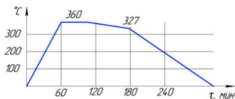
Рис. 2. Схема-график ступенчатой термической обработки Fig. 2. Diagram of stepwise heat treatment
