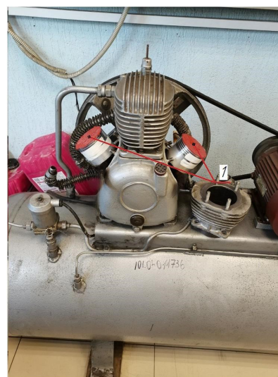
Рис. 3. Компрессор с установленными резиновыми дисками (поз. 1) Fig. 3. Compressor with rubber discs installed (pos. 1)
