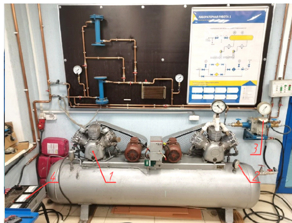
Рис. 2. Фотография лабораторного стенда: 1 — компрессор, 2 — манометр, 3 — счётчик газа, 4 — ваттметр Fig. 2. Photo of the laboratory stand: 1 — compressor, 2 — pressure gauge, 3 — gas meter, 4 — wattmeter
