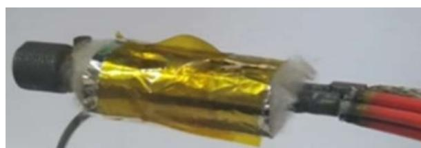
Рис. 3. ЭТМД с двумя АНЭ и теплозащитой
