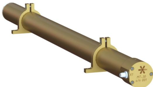
Рис. 2. Магнитный исполнительный орган SX-MT-30 (Максимальный момент 30 А·м²; масса 1,2 кг; габариты 440×50×40 мм) [11]
