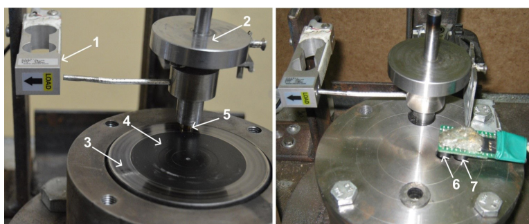
Рис. 2. Элементы конструкции экспериментального стенда: 1 — датчик силы; 2 — груз; 3 — дорожка трения вращающегося диска; 4 — черненная поверхность вращающегося диска; 5 — полимерный образец; 6 — инфракрасный датчик температуры (на дорожке трения); 7 — инфракрасный датчик температуры (на черненной поверхности) Fig. 2. Design elements of the experimental stand: 1 — force sensor; 2 — cargo; 3 — friction track of a rotating disk; 4 — blackened surface of a rotating disk; 5 — polymer sample; 6 — infrared temperature sensor (on the friction track); 7 — infrared temperature sensor (on the blackened surface)
