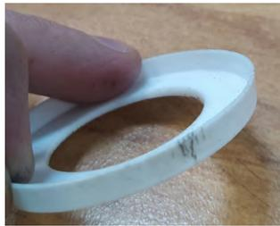
Рис. 2. Образование трещин в процессе механической обработки
