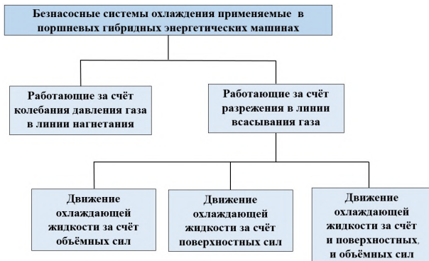
Рис. 2. Классификация безнасосных систем охлаждения Fig. 2. Structure of pumpless cooling systems
