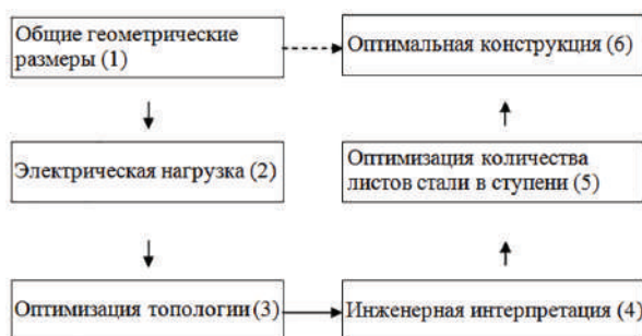
Рис. 4. Схема оптимизации магнитопровода трансформатора в условиях изменяющейся нагрузки
