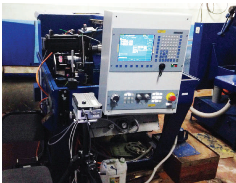
Рис. 5. Фотография установки оптики для юстировки поворотной оси Z
