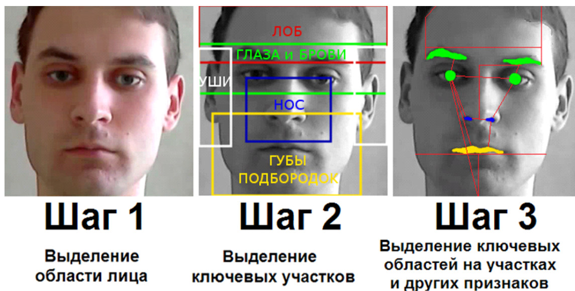
Рис. 2. Выделение признаков в кадре видеозаписи
