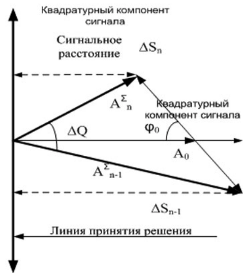
Рис. 2. Формирование относительного сигнального расстояния при относительной фазовой модуляции
