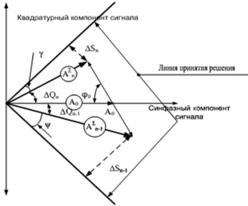
Рис. 6. Формирование относительных сигнальных расстояний для двукратной фазовой и относительной фазовой модуляции для комбинации (0, 0, \pi)
