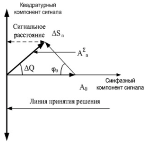
Рис. 1. Формирование относительного сигнального расстояния при фазовой модуляции
