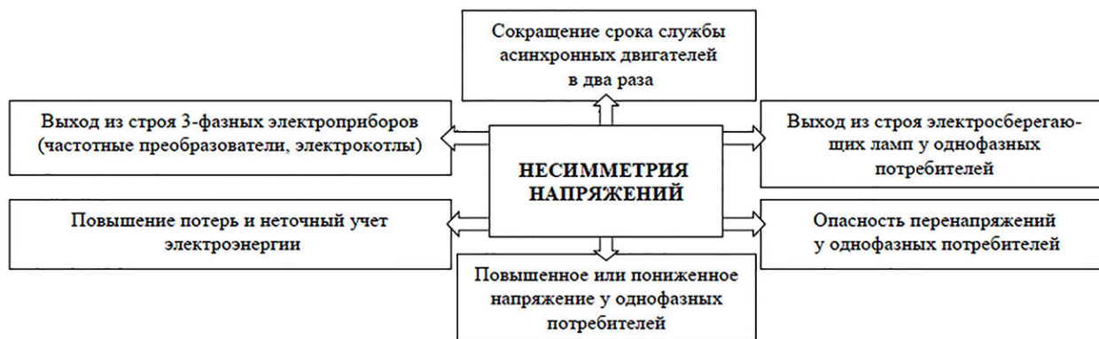
Рис. 1. Последствия несимметрии напряжений
