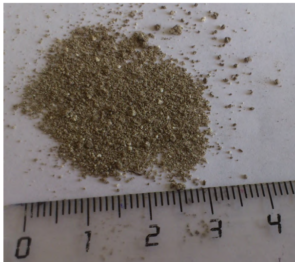
Рис. 1. Капсулированный материал, полученный в результате обезвреживания почвы, загрязненной нефтепродуктами
