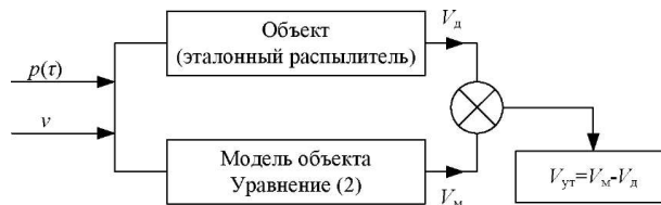
Рис. 2. Схема идентификации утечек в ПП ТНВД
