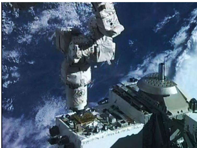
Рис. 10. Манипулятор «Dextre» осуществляет обслуживание модуля RPM
