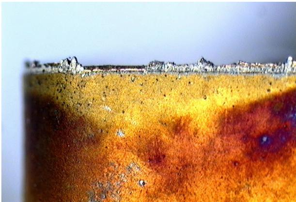
Рис. 4. Наросты на режущей кромке
