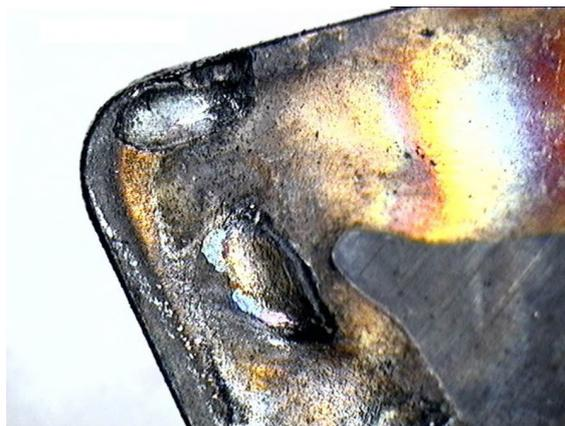
Рис. 3. Лункообразование на режущей пластине
