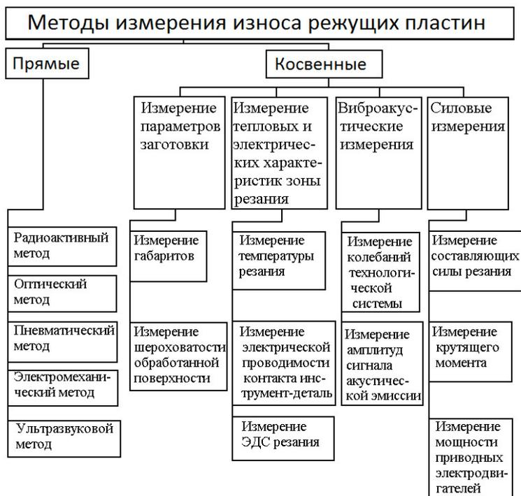
Рис. 1. Методы измерения износа режущих пластин
