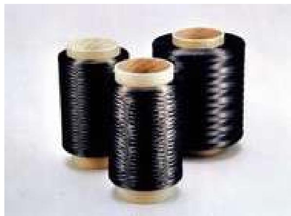
Рис. 3. Волокна углерода, представленные в виде нитей на бобиных
