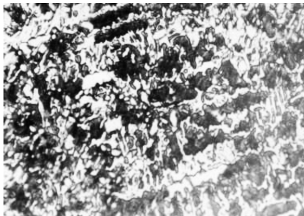
Рис. 4. Микроструктура наплавленного металла после высокого отпуска, \times 320
