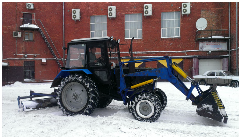
Рис. 1. Дорожная уборочно-подметальная машина на базе трактора МТЗ-80
