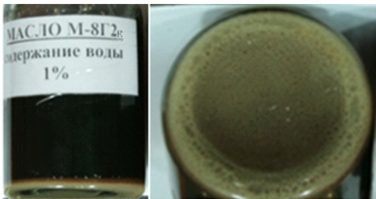
Рис. 1. Образование осадка при 1%-ном обводнении моторного масла М-8Г2к
