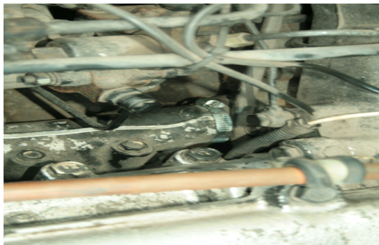
Рис. 2. Датчик температуры охлаждающей жидкости накладного типа, установленный на жидкостной коллектор
