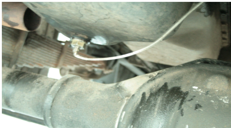
Рис. 1. Датчик температуры масла, установленный на сливную пробку
