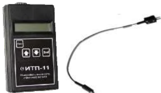
Рис. 3. Внешний вид ИТП-11; внешний вид хром-алюминиевой термопары
