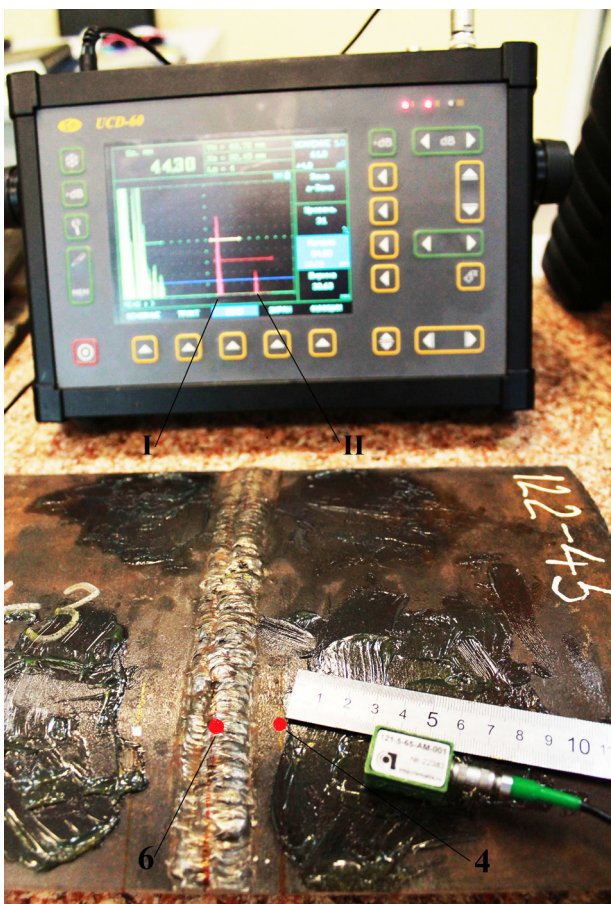
Рис. 3. Эхо-сигналы дефектов: I — эхо-сигнал от околошовного дефекта 4; II — эхо-сигнал от околошовного дефекта 6.
