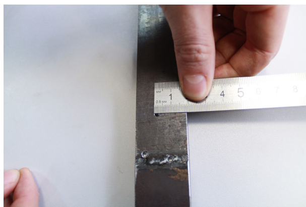
Рис. 7. Образец с искусственно нанесенными дефектами
