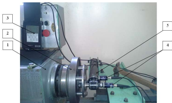
Рис. 1. Стенд-имитатор инерционного нагружения направляющей втулки штока гидравлического амортизатора с вибронализатором «Диана 2М»: 1 — токарный станок; 2 — план-шайба; 3 — анализатор вибраций «Диана-2М»; 4 — пьезоакселерометры; 5 — гидравлический амортизатор
