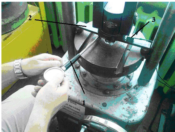
Рис. 8. Установка в сборе: 1 — микрометр лабораторный; 2 — образец № 6; 3 — ПЭП
