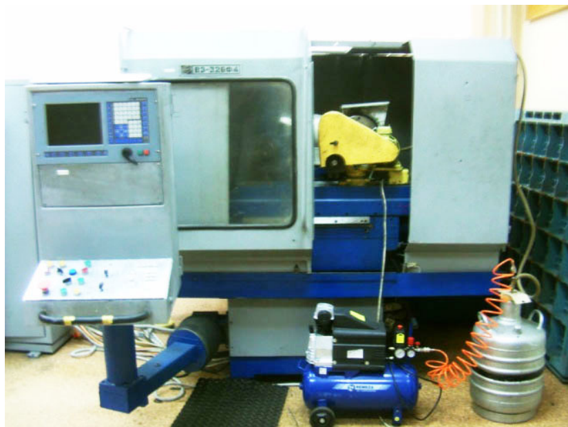
Рис. 1. Система высокоскоростного метода, доработанная системой подачи жидким азотом
