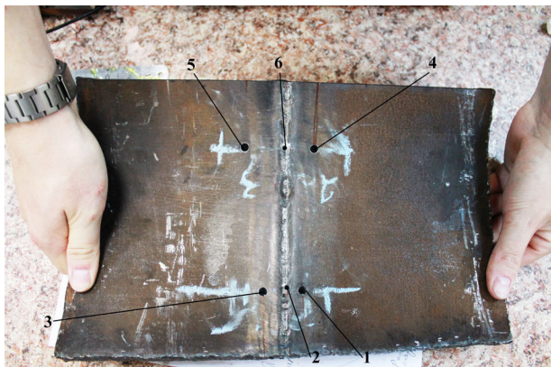
Рис. 1. Образец листовой стали с искусственными дефектами
