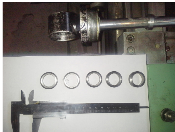
Рис. 2. Имитация износа направляющей втулки
