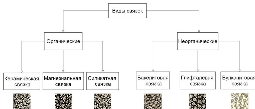
Рис. 3. Виды связок, используемые в абразивных инструментах
