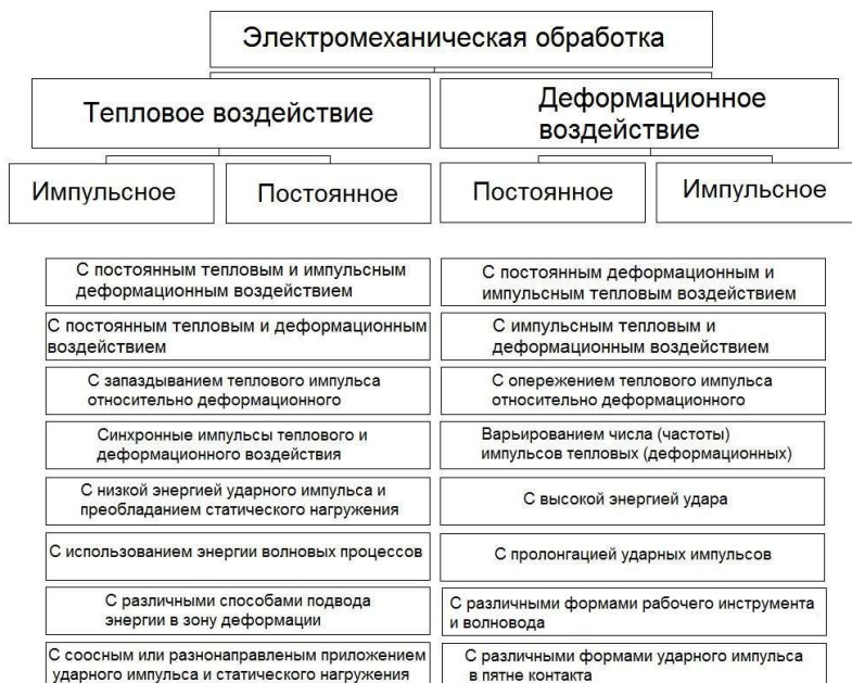
Рис. 1. Схема различных сочетаний теплового и деформационного воздействий при ЭМО
