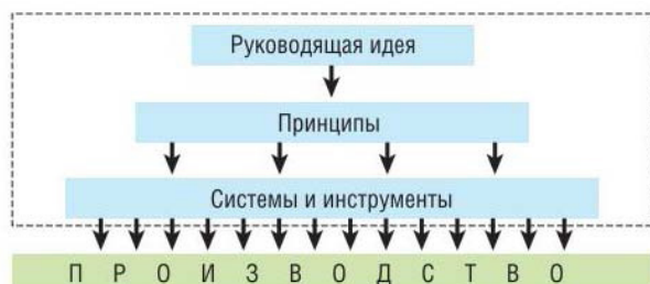
Рис. 1. Структура подхода бережливого производства (обведена пунктиром)
