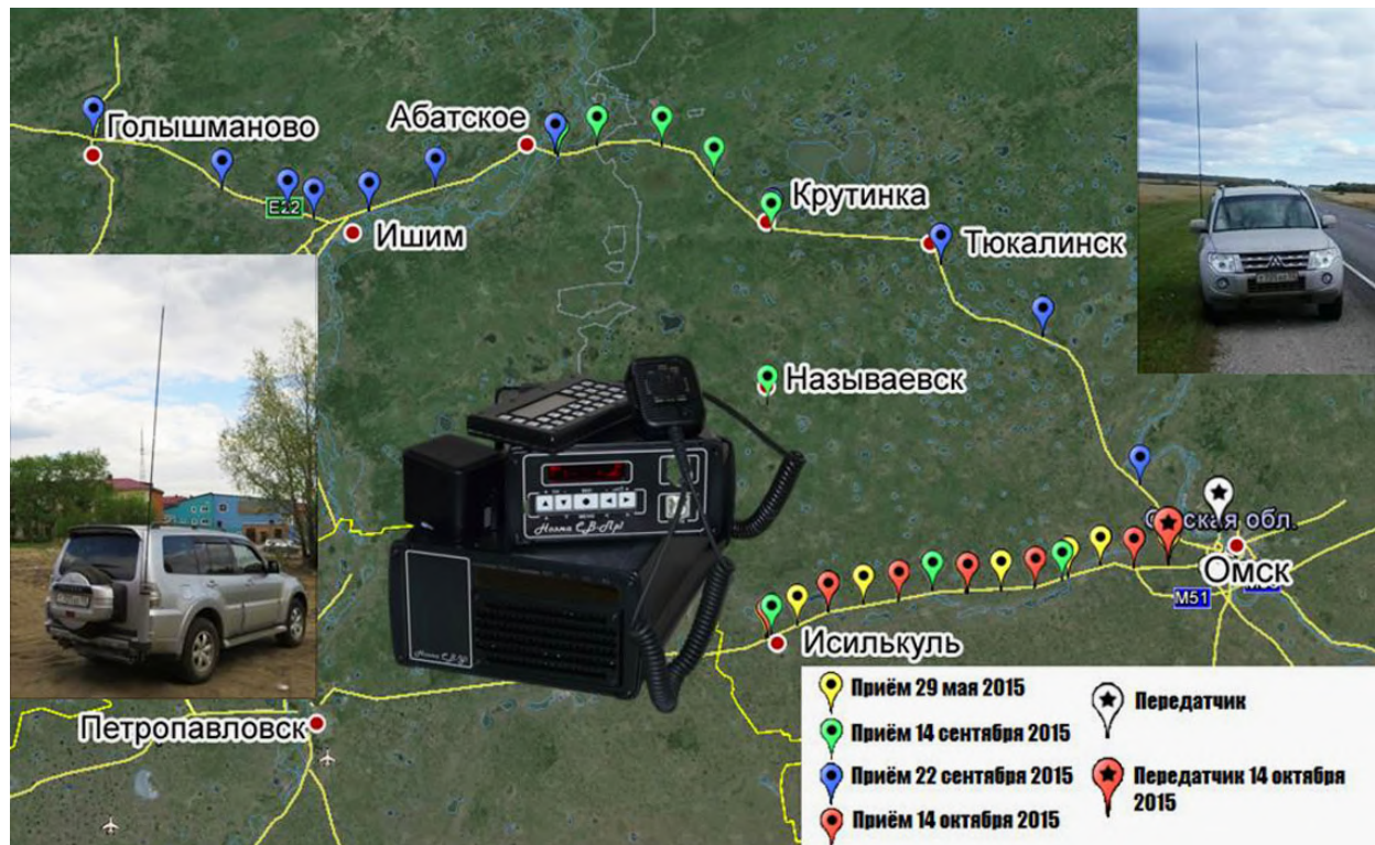
Рис. 5. Результаты испытаний для определения потенциальной дальности передачи сигналов на частоте 500 кГц
