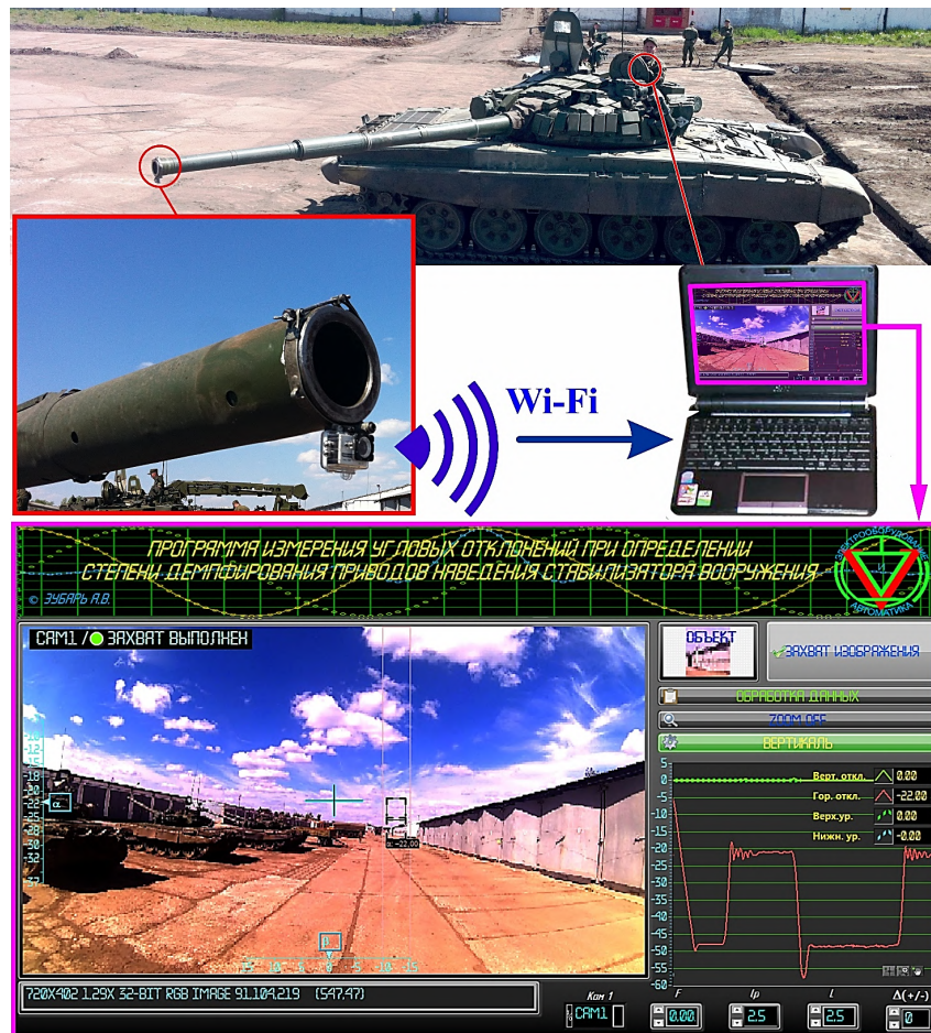
Рис. 5. Экспериментальная проверка программы измерения угловых отклонений стабилизатора вооружения и её интерфейс
