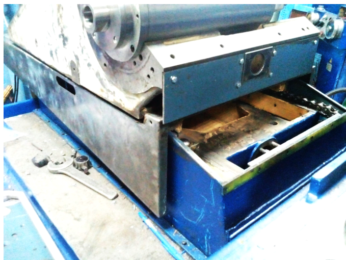
Рис. 4. Фотография салазок станка со снятым кожухом
