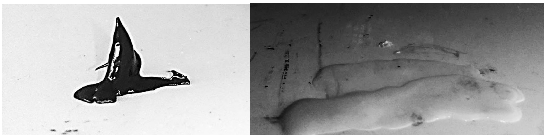
Рис. 4. Форма капли композиции парафина и технического углерода (слева) и чистого парафина (справа)
