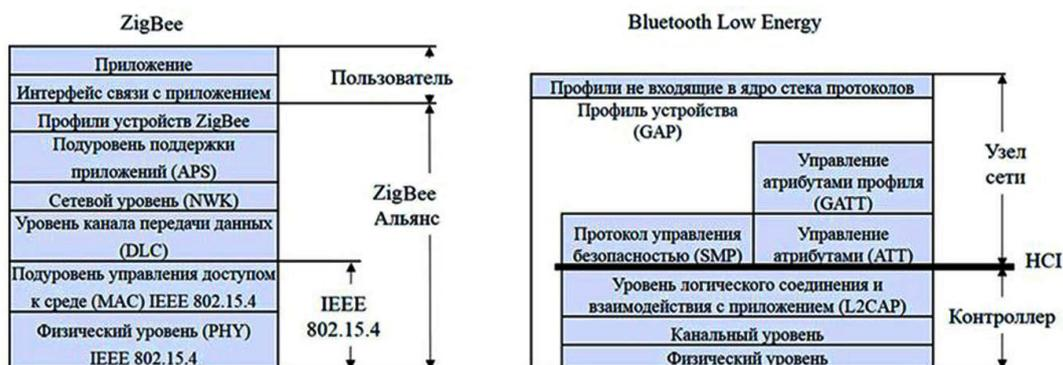
Рис. 1. Архитектура стеков протоколов технологий Bluetooth Low Energy и ZigBee
