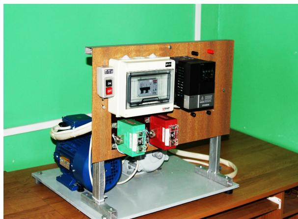
Рис. 4. Электрическая схема (а) и внешний вид лабораторного стенда (б) по исследованию характеристик опытного образца синхронного генератора
